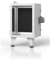
Filtermodul: 2. Filterstufe in Zuluft mit Panelfilter ISO ePM1 80 % (F9), inkl. Differenzdruckschalter zur Filterüber- wachung
