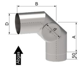
511KS5###L Bogen 87° mit seitlicher Reinigung links RG:51
