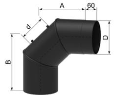
294091### Rundrohrbogen geschweisst 90° mit Reinigung RG:29
