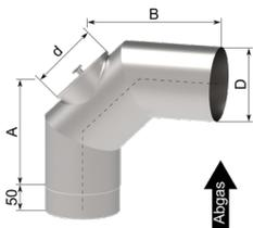
511KS5###R Bogen 87° mit seitlicher Reinigung rechts RG:51
