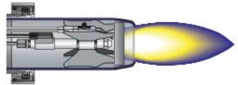
Universalbrenner mit kurzem Brennerrohr und leistungsstarkem, laufigem Gebläse. Durch die spezielle Mischeinrichtung wird ein Blauflammenanteil erreicht. Somit reduzierte Stickoxid -und CO-Emissionen. Emissionsklasse 3 nach DIN EN267 Die beste aktuelle Einstufung bei dieser Brennerart.
