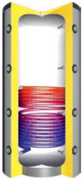
HAPSR 500 - 1.000 Pufferspeicher aus Stahl S235 mit 1 Wärmetauscher, Betriebsdruck 3 bar, max. Betriebstemperatur 95°
