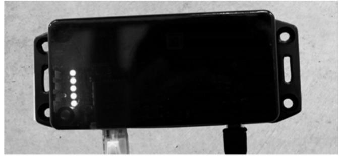
Abb. 4: LANfunk-Box mit 5 leuchtenden LED-Lampen
