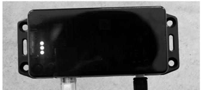
Abb. 5: LANfunk-Box mit 3 leuchtenden LED-Lampen
