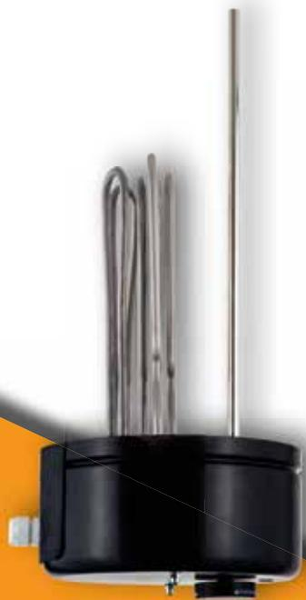
Spezialausführung zur Erwärmung von Wasser, CNF5-Rohrheizkörper (Incoloy/Chrom-Nickel-Stahl) auf Flanschplatte isoliert aufgesetzt montiert (Schutzstrom- Ableitwiderstand), mattschwarze Schutzkappe, von außen einstellbarer Temperaturregler, allpoliger Sicherheits-Temperaturbegrenzer, Flanschdichtung.
